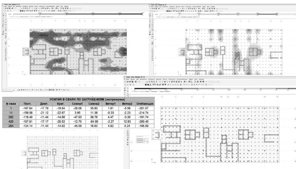
Рис.3 Реакції та огинаючі реакції в палях і розрахункове армування фундаментної плити в ПС «ПЛИТА»
